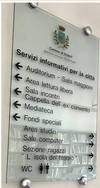
Questo tipo di indicazione è difficilmente leggibile, per gli effetti di riflesso, di ombra proiettata, manca dell'impiego di una pluralità di canali che agevolano la comprensione (pittogrammi, testi leggibili, colori, sistematicità di collocazione, leggibilità da parte di persone con disabilità visive o intellettive)
